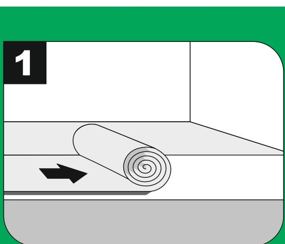
**7.1** Для обеспечения комфорта при эксплуатации расстилается плотная подложка толщиной 1,5 мм. Подложка укладывается встык и закрепляется при помощи клейкой ленты по всей длине стыка.
