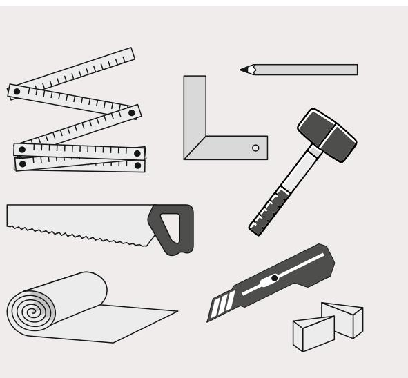
**6.1** Для укладки SPC-покрытия высокой плотности (кварцевого ламината Home Expert) потребуются линейка, карандаш, пила (или электролобзик), угольник, распорные клинья, нож, резиновая киянка, плотная подложка толщиной 1,5 мм.
